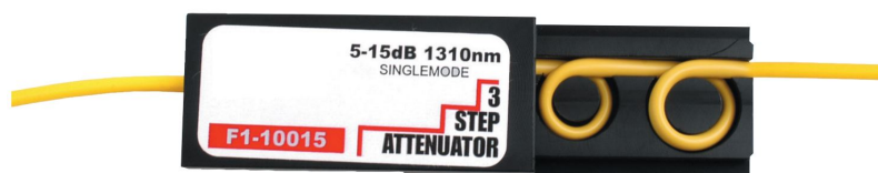
Obrázek 2.12: Atenuátor tvořený ohybem vlákna [21]
